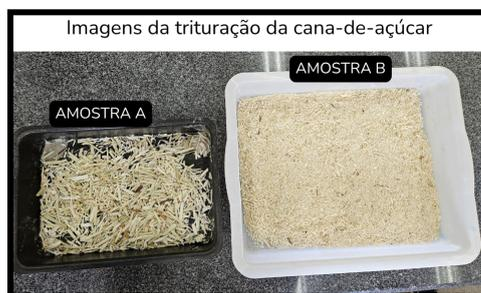
FIGURA 1. Trituração da cana-de-açúcar em dois tamanhos diferentes
