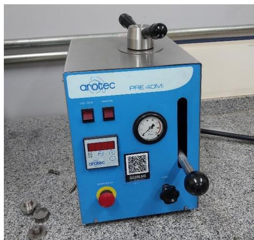
FIGURA 2. Prensa de embutimento. Fonte: próprio autor.
