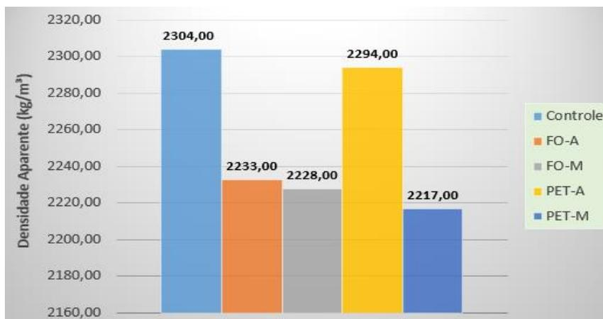
FIGURA 2. Densidade Aparente das Misturas de Argamassa com adição de Fibras.
