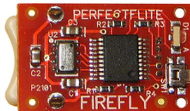
**FIGURA 3:** Altímetro Firefly. Fonte: PERFECTFLITE(2017).
