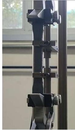
Figura 4: Corpo de prova submetido a ensaio de tração
