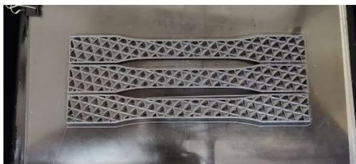
Figura 3: 3 corpos de prova de preenchimento octeto durante o período de manufatura
