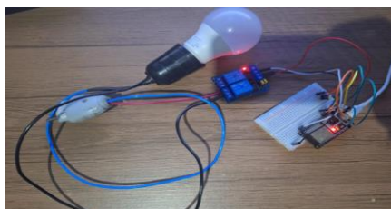
Figura 4. Protótipo do sensor de luminosidade físico.
