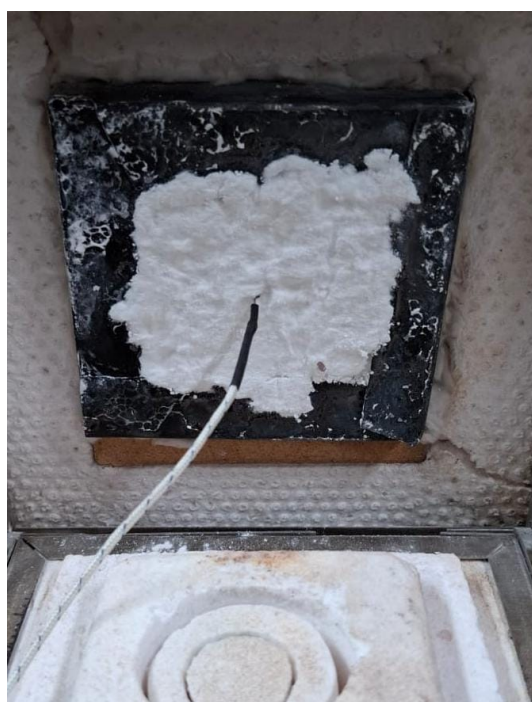
FIGURA 3. Fibras em teste de condutividade térmica, fechando a porta do forno e medindo a temperatura externa com termopar.
