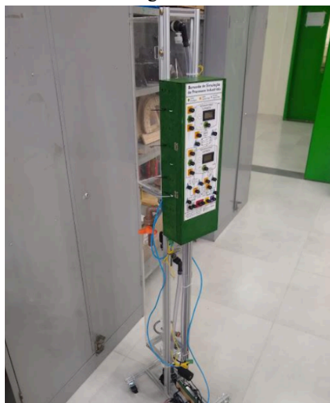
FIGURA 4. Montagem das caixas de comando.
