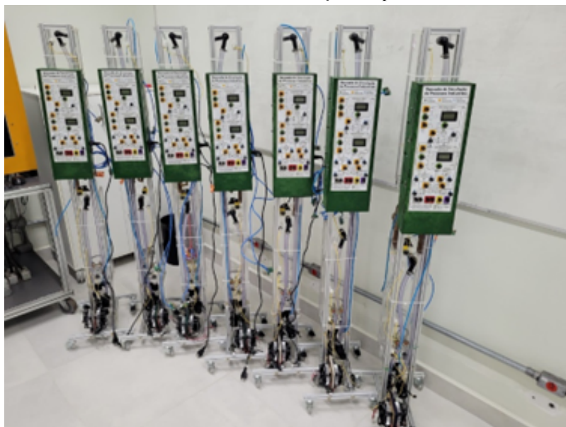
FIGURA 1. Bancadas de simulação de processos industriais
