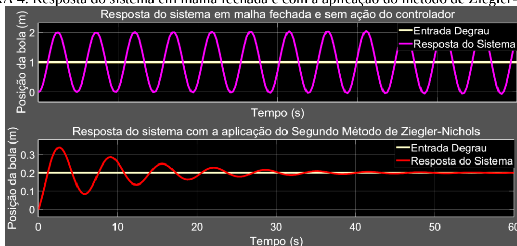
FIGURA 4. Resposta do sistema em malha fechada e com a aplicação do método de Ziegler-Nichols.
