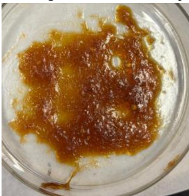
Figura 2. Bioplástico com gel de Aloe vera e HCl.
