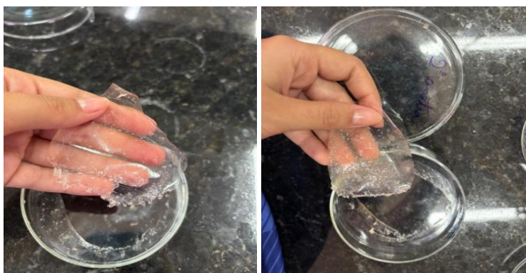
Figura 3. Bioplástico com gel de Aloe vera , amido, ácido acético e glicerina.
