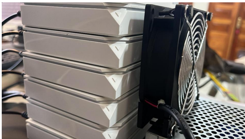
FIGURA 3. Cooler adicionado para auxiliar a refrigeração.
