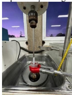
FIGURA 2. Sistema para reação de glicerólise enzimática
