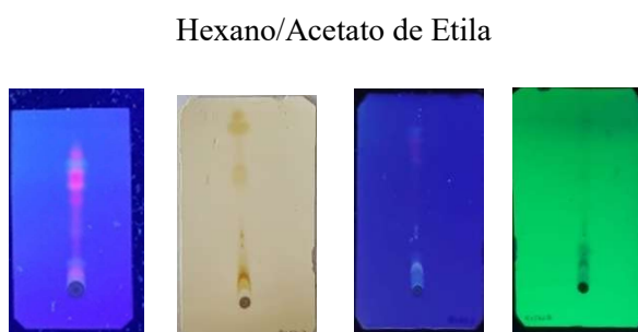
FIGURA 2. Cromatoplas do extrato alcoólico de H. sabdariffa (fase estacionária: sílica-gel; reveladores: Luz UV-Vis, Iodo, e Luz UV- comprimentos de onda de 245 e 315, respectivamente).
