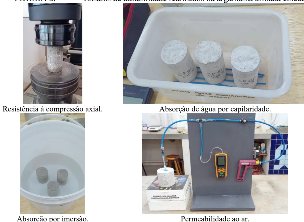
FIGURA 2. Ensaios de durabilidade realizados na argamassa armada coletada.
