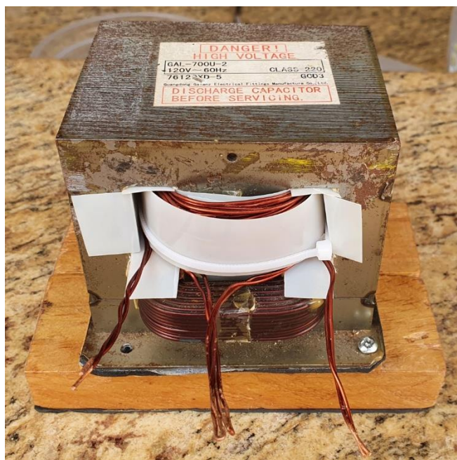
FIGURA 1 – Transformador de Micro-Ondas utilizado para os ensaios descrito neste artigo Fonte: do autor
