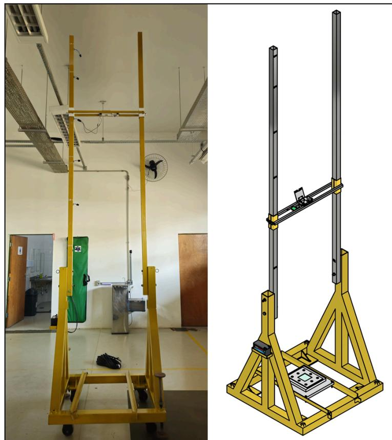
FIGURA 4. Estrutura final da máquina de impacto por queda livre e sua representação em vista isométrica através do *Inventor*®.
