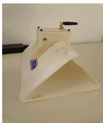
Figura 3. Armadilha Delta com o Dispositivo Inteligente
