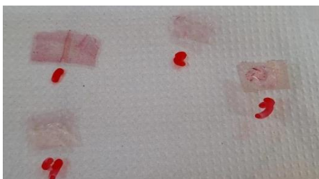
Figura 2. Películas de diferentes tratamentos frente à ação de um ácido (HCl).
