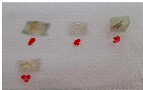
Figura 3. Películas de diferentes tratamentos frente à ação de uma base (NaOH).
