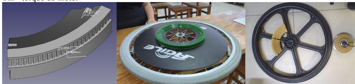
FIGURA 2. Montagem das engrenagens nas rodas.
