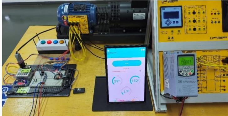
FIGURA 3. Bancada para ensaios e validação do projeto SMART ENGINE.
