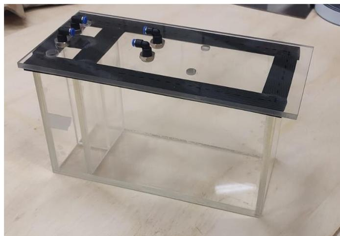
FIGURA 10. Posicionamento da tampa em relação a estrutura principal do eletrolisador.
