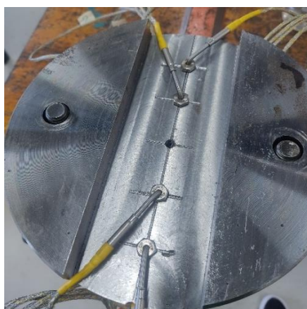
Figura 4. Fixação dos termopares na parte inferior da base.
