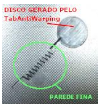
FIGURA 2. Amostra impressa à 200 °C, 90 mm/s, orientação 45° com espessura de 0.2 mm.
