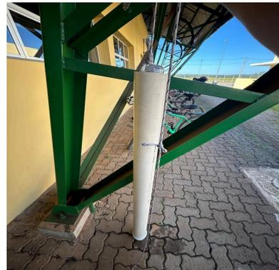
FIGURA 4. Coluna d'água para verificação da vedação do pote. (fonte: próprio autor)
