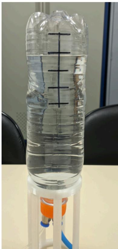
**Figura 2:** Recipiente de coleta de H<sub>2</sub> graduado em incrementos de 50cm<sup>3</sup>
