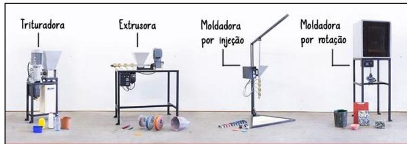
**Figura 1.** Equipamentos para reciclagem de plástico do projeto *Precious Plastic* (Borges, 2017).
