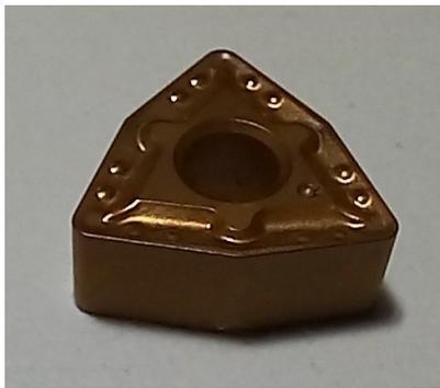
FIGURA 1. Ferramenta de corte utilizada, TaeguTec WNMG 060408 MT TT8125.
