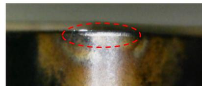
FIGURA 8. Foto tirada por uma câmera de alto aumento da aresta de corte desgastada.
