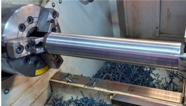
FIGURA 3. Fixação do corpo-de-prova na máquina em placa e contraponto.
