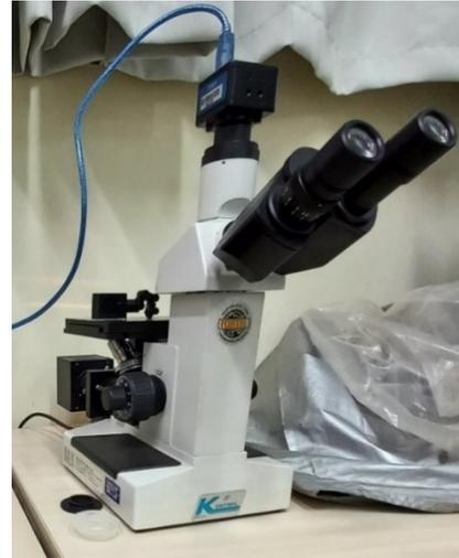
FIGURA 4. Microscópio com a câmera utilizados para medir as ferramentas.
