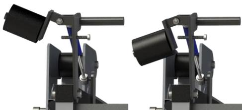
FIGURA 10. Regulador angular modelado.
