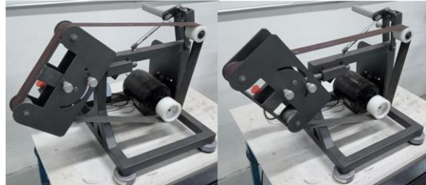
FIGURA 8. Deslocamentos angulares do cabeçote articulado fabricado.
