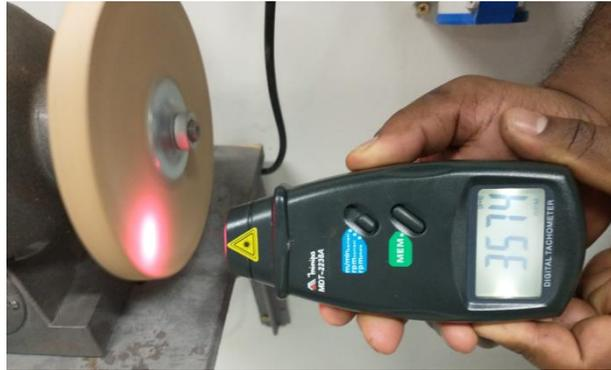
FIGURA 3. Medida da rotação do motor elétrico através do tacômetro digital.
