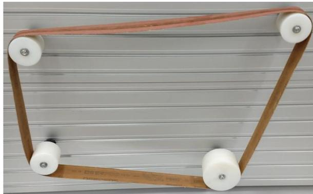
FIGURA 1: Lixa de cinta com 2 m de comprimento e 50 mm de largura.
