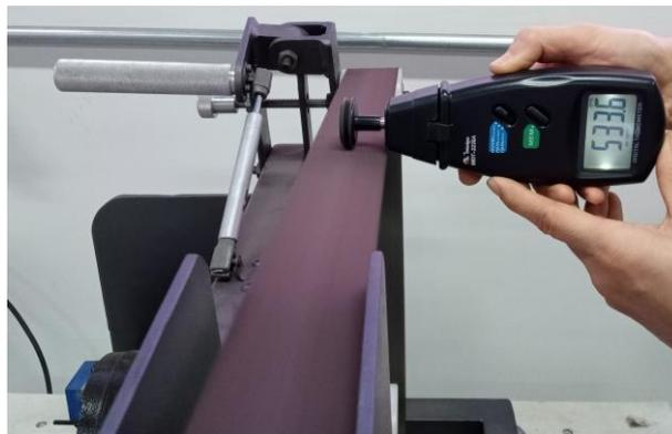
FIGURA 6. Medida da velocidade linear desenvolvida pela lixa de cinta através do tacômetro digital.
