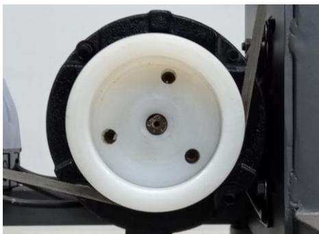
FIGURA 4. Polia motora de nylon fabricada com 100 mm de diâmetro
