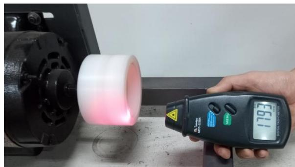
FIGURA 5. Medida da rotação do novo motor elétrico através do tacômetro digital.
