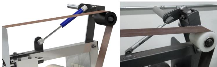
FIGURA 9. Amortecedor conectado ao braço da polia tensionadora modelado e fabricado.
