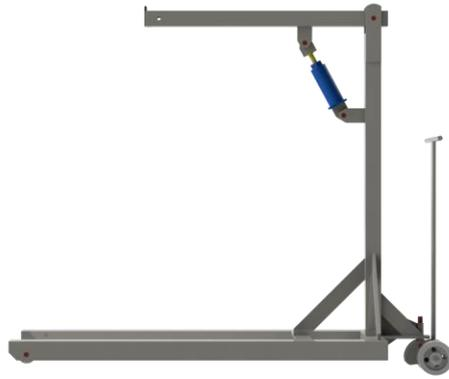
FIGURA 5. Guincho com o macaco hidráulico na posição inclinada em relação à vertical.
