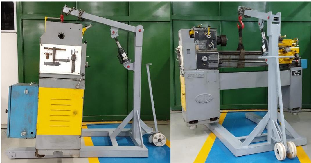
FIGURA 9. Guincho hidráulico fabricado elevando o torno convencional.
