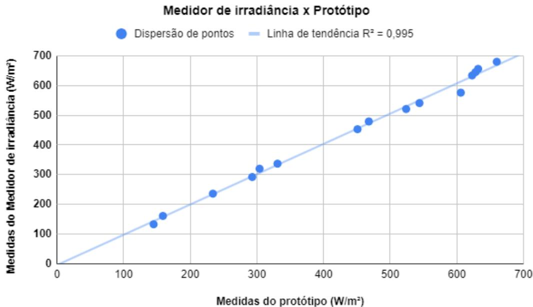
FIGURA 4: Medidor de irradiância x Protótipo
