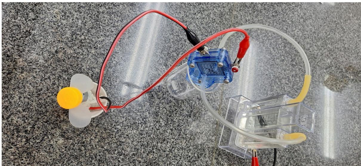
FIGURA 2. Montagem dos principais componentes da demonstração da energia gerada pela célula combustível.
