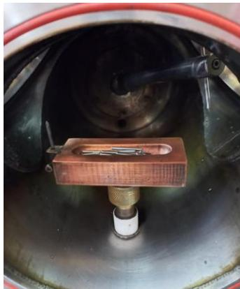
Figura 1. Elementos precursores dentro do cadinho do forno arco voltaico
