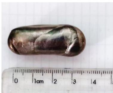
Figura 2. Lingote de Ti-20Zr.
