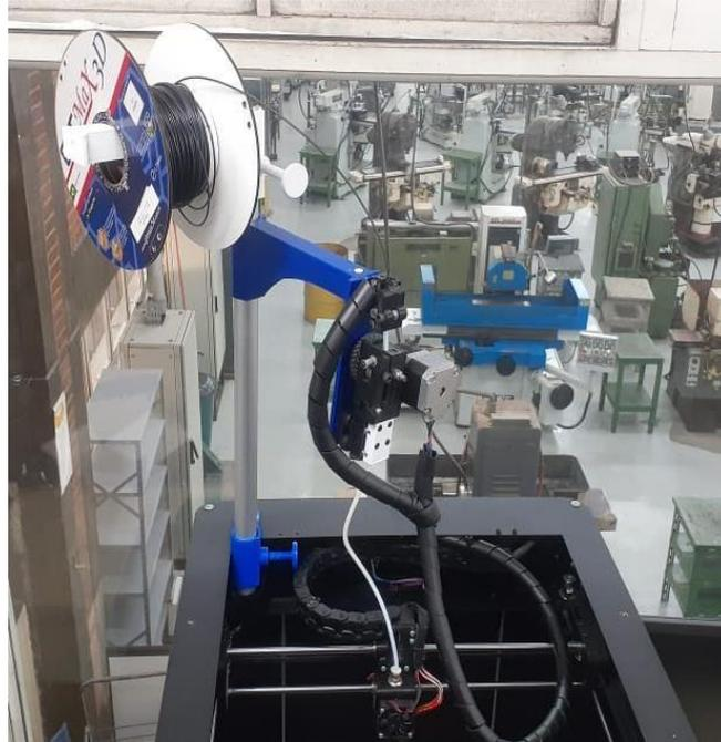
FIGURA 6. Segundo suporte construído com peças impressas em PLA e ABS com realocação da fiação elétrica.
