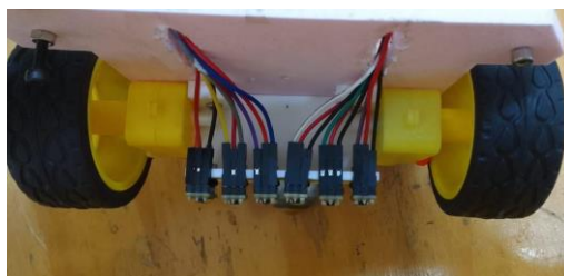
FIGURA 3. Suporte dos sensores com os sensores posicionados abaixo do eixo das rodas.
