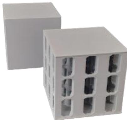
FIGURA 2. Peças impressas, corpo otimizado e corpo de preenchimento convencional.
