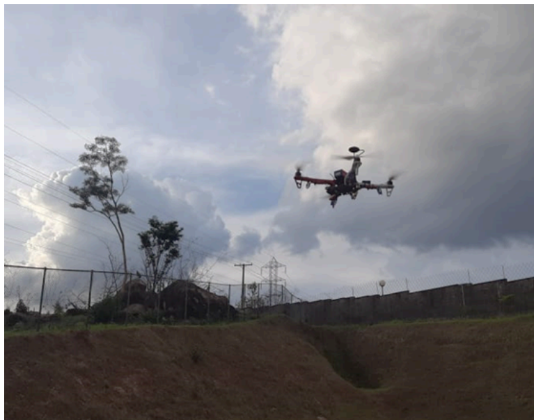
FIGURA 4. Drone durante teste de voo automático com base na rota pré definida no Mission Planner. Fonte: Acervo do autor.
