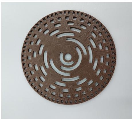
Figura 5: Disco de fendas impresso em 3D (Os autores, 2024)
