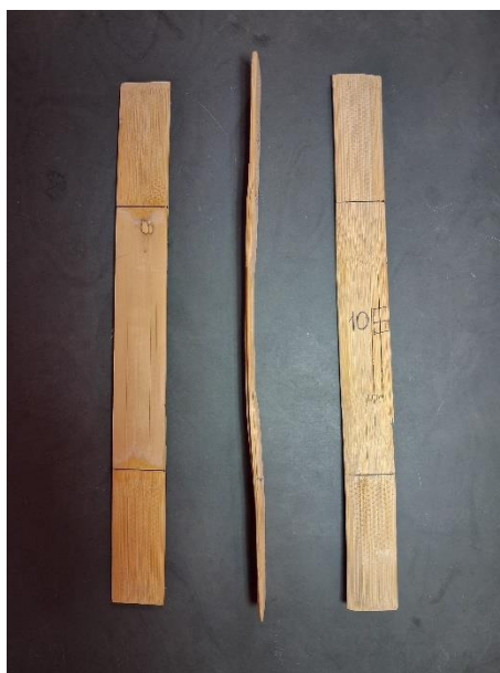
FIGURA 06. Corpo de prova externo após o ensaio de tração paralela às fibras Fonte: Próprio autor (2024)
