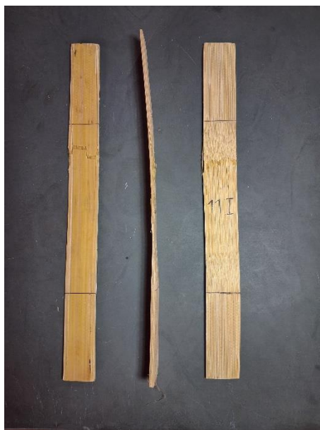
FIGURA 05. Corpo de prova interno após o ensaio de tração paralela às fibras Fonte: Próprio autor (2024)
