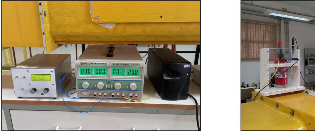
FIGURA 4. Fonte de alta tensão (esquerda) e bobina de ignição (direita).
